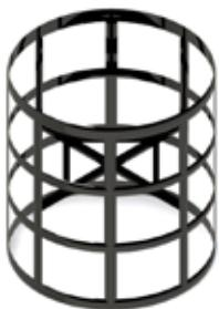
PP (Polipropilen) Bigudi tipi dolgu; orta kirli sularda, ortamin kirli ve tozlu olduğu, askıdaki katı madenin fazla olduğu, suyun kireçlenmeye eğilimli olduğu sistemlerde tercih edilir. Polipropilen malzemeden imal edilen bu dolgu, 90 °C sıcaklığı kadar dayanıklıdır. Kullanım ve temizlenmesi pratik bir dolgu çeşididir.
